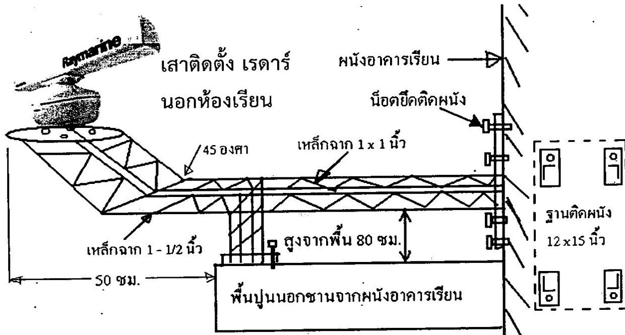
โครงโดยรอบเป็นเหล็กฉาก 1 - 1/2 นิ้ว หนา 1 ทุน ไรสนิม เบอร์ 316 เหล็กถักของโครงใช้ เหล็กฉาก 1x 1 นิ้ว หนา 1 ทุน ฐานวางเท่าน้ำยาอากาศเรดาร์ สีเหลี่ยม หนา 10 มม. 12 x 15 นิ้ว ฐานยึดคีบผนังห้องเป็นแผ่นสีเหลี่ยม 5 x 5 นิ้ว 10 มม. เจาะรู
