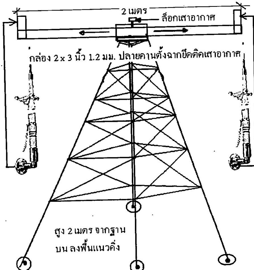
โครงสร้างเป็นเหล็กจาก 1 - 1/2 นิ้ว 1 หุน ไร้สนิม เบอร์ 316 ฐาน
