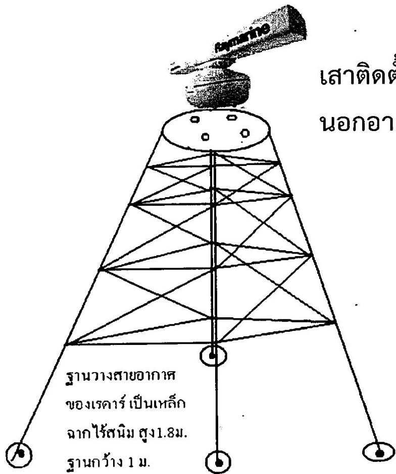
โครงสร้างเป็นเหล็กจาก 1 - 1/2 นิ้ว 1 ทุน ไส้สนิม เบอร์ 316 ฐาน
